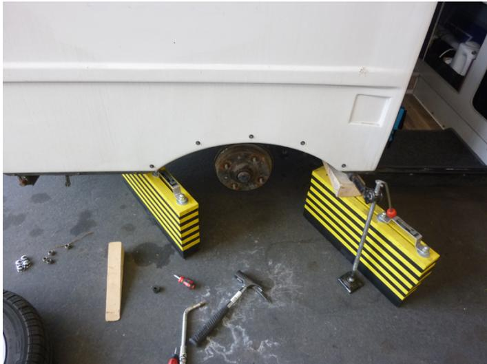
Mit einem zweiten Wagenheber die Achse wieder anheben und die zwei Achsfangbänder lösen (13er Schlüsselweite). Dann die Achse mit dem Wagenheber wieder ganz ablassen; nun kann man die Feder einfach rausnehmen:
