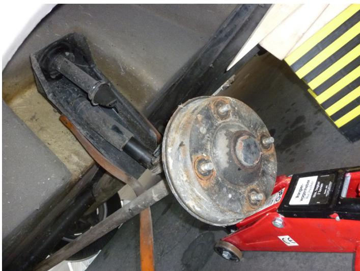
Jetzt hätte man natürlich genug Platz um die Stoßdämpfer ebenfalls mit zu wechseln, wenn man denn die richtigen da hätte. Falls dem nicht so ist, neue Feder einsetzen, ggf. vorher die Gummiauflagen tauschen. Achse wieder mit dem Wagenheber anheben, Achsfangbänder wieder anschrauben:
