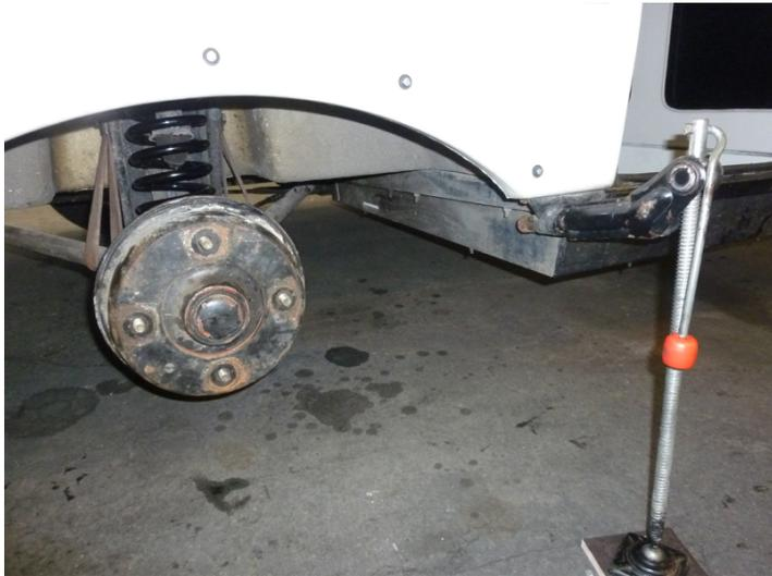
Kleine Schraube in der Bremstrommel lösen, Bremstrommel abnehmen (Bremse muss natürlich gelöst sein), Fettkappe abnehmen:
