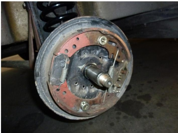
Es bietet sich natürlich jetzt an, die Bremse mit Bremsenreiniger zu reinigen und ggf. die Bremstrommel zu lackieren.
