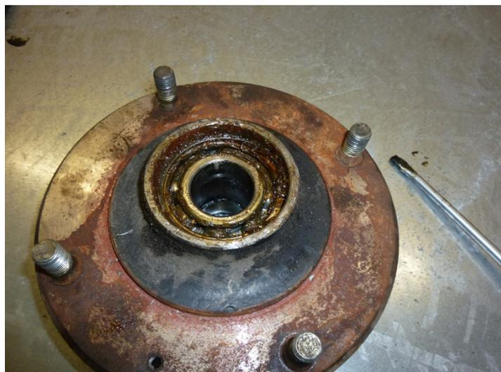
Und einmal umgedreht – Wellendichtring und inneres Radlager (der QEK hat auf jeder Seite zwei (!) Radlager):
