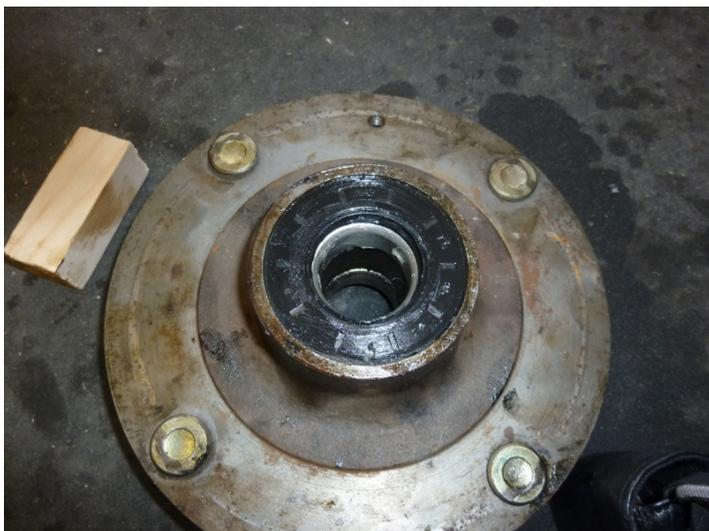
Umdrehen - das äußere Lager ist mit einem Sicherungsring (Seegerring) befestigt, diesen mit einer entsprechenden Zange lösen und entnehmen:
