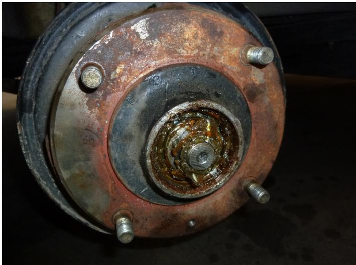
Man kann es auf dem letzten Bild nicht ganz so gut erkennen, aber auf dem Achsstummel befindet sich eine Kronenmutter (30er Schlüsselweite) nebst Unterlegscheibe und einem Sicherungssplint. Nachdem der Sicherungssplint entfernt wurde, kann die Kronenmutter gelöst werden und mitsamt der Unterlegscheibe entfernt werden.
