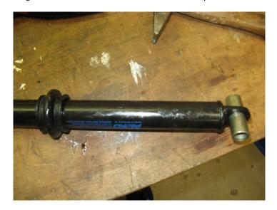
Den neuen Auflaufdämpfer in das Tauchrohr hereinschieben, alles gut fetten und zusammensetzen. Zusammensetzen würde ich wie folgt:
