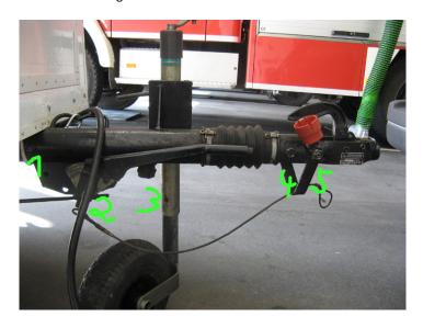
Schraube Nr. 2: Lösen, Handbremshebel abnehmen
