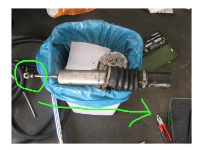
Öse und Mutter (grüner Kreis im oberen Bild) vom Auflaufdämpfer abschrauben und den Auflaufdämpfer mitsamt Distanzhülse in Pfeilrichtung aus dem Tauchrohr schieben. Ich habe dann erstmal das Tauchrohr geputzt.
