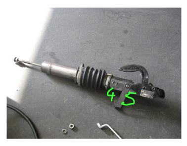
Schraube Nr. 5 mit im Tauchrohr befindlicher Distanzhülse rausnehmen.
