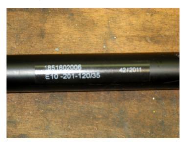
Zum Wechsel des Auflaufdämpfers schauen, dass der Dämpfer voll ausgefahren ist, sonst ggf. von Hand am Anhänger-Zugmaul ziehen, sodass der Dämpfer ausgefahren ist. Es gibt natürlich verschiedene Ablauf-Reihenfolgen, alles habe ich nicht auch nicht geknipst und einiges ist auch selbsterklärend wenn man davor steht.
